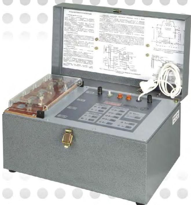
Устройство определения тока короткого замыкания в сетях постоянного тока «Импульс» предназначено для определения тока короткого замыкания на шинах и присоединениях сетей постоянного тока напряжением 24 – 220 В с целью выбора уставок защитных автоматов и плавких предохранителей.
