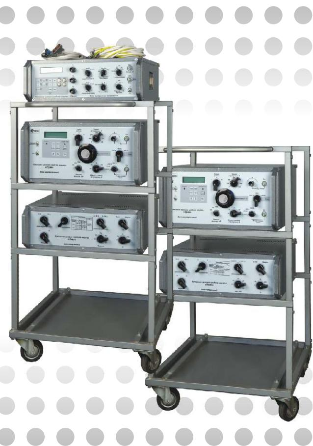
Блок можно использовать как источник однофазного переменного напряжения с плавной регулировкой выходного сигнала в диапазонах: 0,1 – 195 В с максимальным током 0,5 А; либо 0,02 – 65 В с максимальным током 1,5 А, а также как источник однофазного переменного тока с плавной регулировкой сигнала в диапазоне 0,1 – 15 А.
