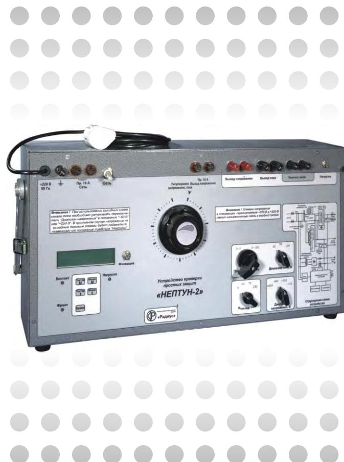
Встроенные средства измерения устройства «Нептун-2» имеют цифровой отчет показаний. При измерении напряжения или тока срабатывания дополнительно рассчитывается коэффициент возврата проверяемого реле с возможностью усреднения по нескольким замерам. На индикаторе одновременно отображаются текущие выдаваемые значения тока и напряжения выбранного выходного канала, в зависимости от нажатой кнопки «Канал II» или «Канал I».
