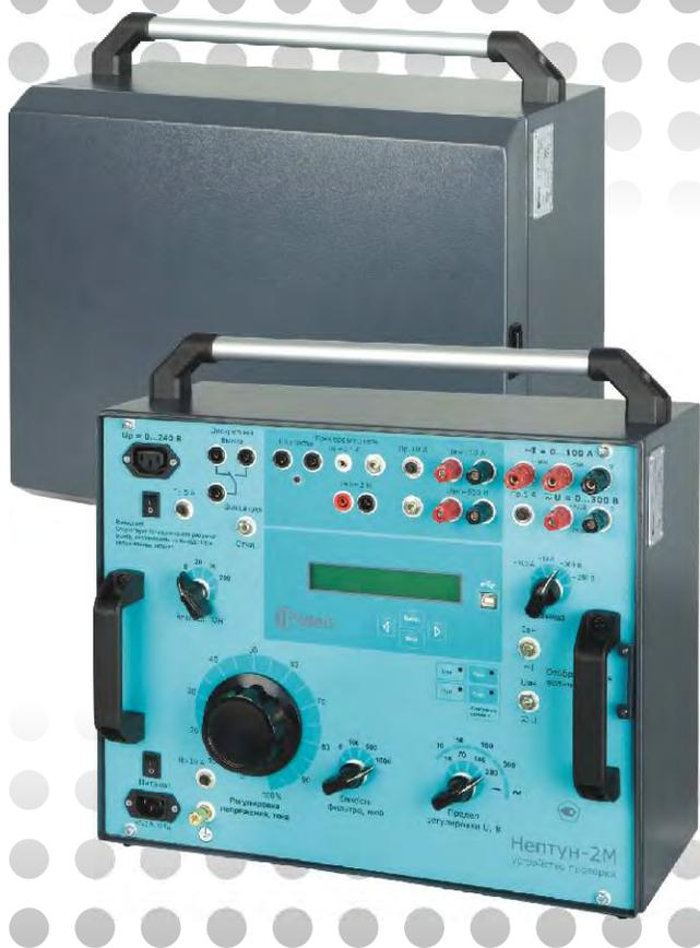
Максимальная выходная мощность устройства составляет 1400 ВА. Регулировка выходных значений осуществляется с помощью ЛАТРа, а форма выходного напряжения или тока соответствует форме напряжения сети.
