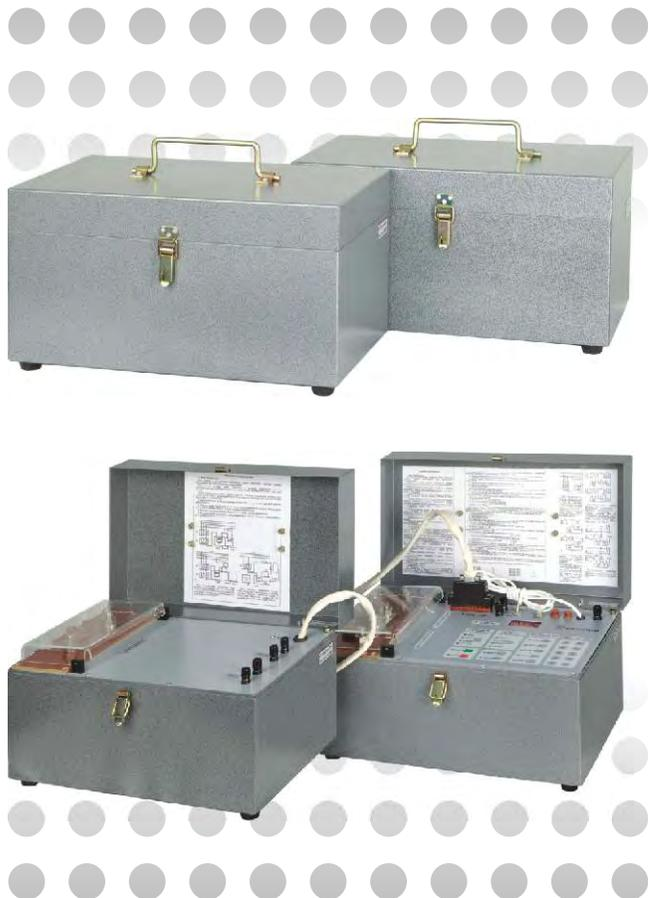
Испытательные устройства «Сатурн-М», «Сатурн-М1» предназначены для проверки автоматических выключателей с тепловыми и электромагнитными расцепителями присоединений напряжением 220—380 В частоты 50 Гц как подключенных к сети, так и отсоединенных от нее.
