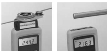
Механическое измерение со счетчиком для нити
