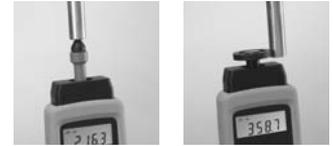
Механическое измерение с наконечником зонда
