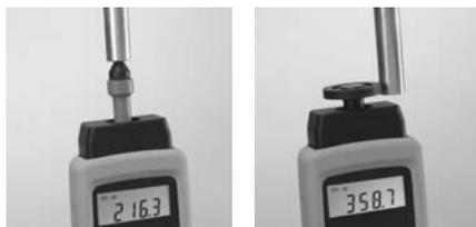
Механическое измерение с наконечником зонда
