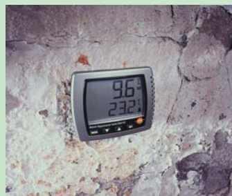
Мониторинг и контроль точки росы позволяет избежать образования плесени
